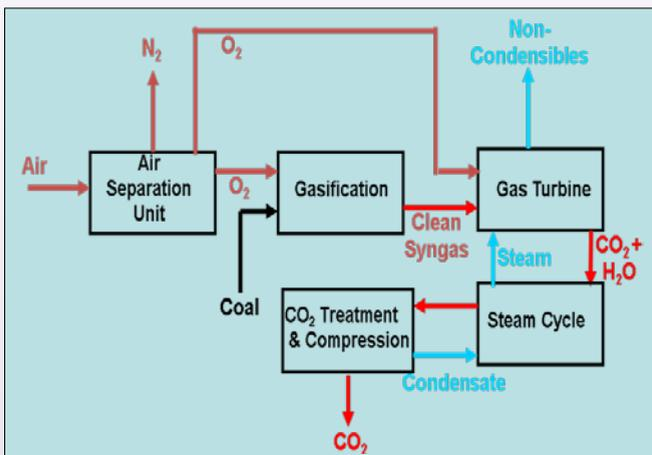
**GAS TURBINE BASED COAL FUELED OXY COMBUSTION CONCEPT**
