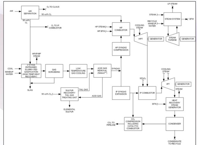
**SYSTEMS INTEGRATION IN GAS TURBINE BASED COAL FUELED OXY COMBUSTION POWER PLANT**
